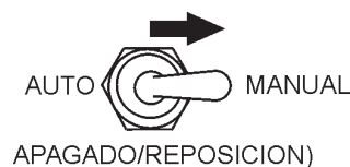
Figura 41. Interruptor de control MPEC (Posición manual)
