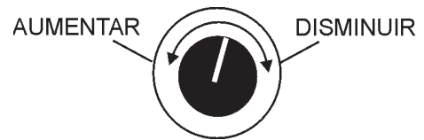
Figura 11. Perilla del control regulador de voltaje
