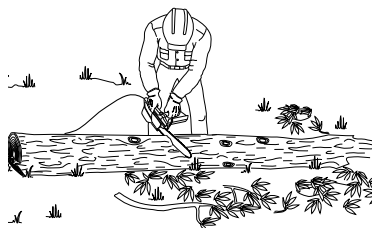
Figure 13 - Bucking Log With Entire Length On Ground Figura 13 - Trozado del tronco completamente apoyado en el suelo Figure 13 - Tronçonnage d'une bille qui repose entièrement au sol
