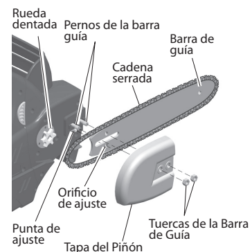
Figura 36- Reemplazo de la barra guía y de la cadena de la sierra
