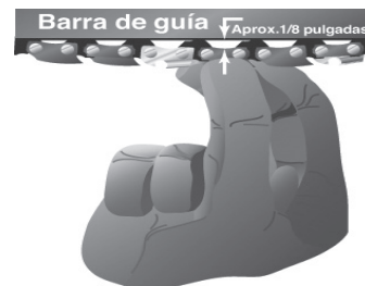
Figura 8 - Compruebe la tensión de la cadena
