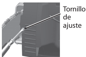
Figura 10 - Giro del tornillo de regulación.
