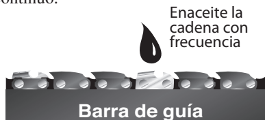
Figura 12 - Aplicación de aceite a la cadena
