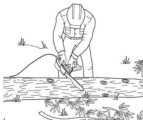
Figure 14 - Tronçonnage d'une bille qui repose entièrement au sol
