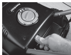
Figure 15 - Branchement de la rallonge électrique
