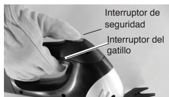
Figura 2 - Oprima el interruptor de seguridad y del gatillo
