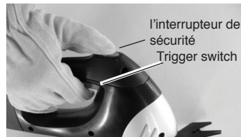
Figure 2 - Repoussez l'interrupteur de sécurité au moyen du pouce, puis appuyez sur la gâchette.
