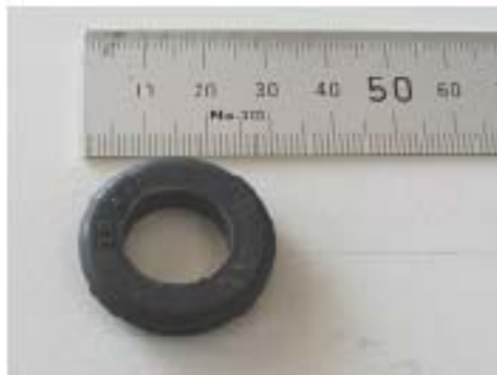
Grommet Bleed Valve. P/No 999236
