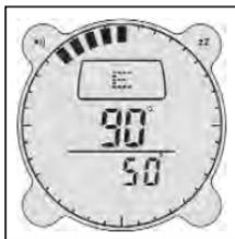
rumbo en incrementos de diez. Una simple pulsación del botón **UP** o **DOWN** mueve el rumbo 1 grado. Cuando termine, pulse el botón **ADJ** para regresar a la Modalidad de indicación del rumbo. Para volver a la Modalidad de Brújula pulse el botón **MODE**.
