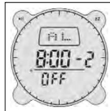
La alarma también se puede encender o apagar si va a la alarma pertinente y pulsa el botón **COMP** para activar la función de alarma; pulse el botón otra vez para activar la función Snooze (alarma repetitiva), y vuelva a pulsarlo para desactivar la alarma.
