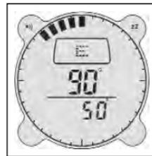
Pour utiliser le navigateur numérique au Homing Mode (mode autoguidage), passez d'abord au Compass Mode (mode navigateur) puis appuyez sur le bouton **MODE** pour accéder au mode autoguidage.
