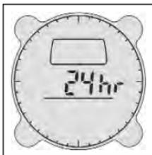
Für die Einstellung 24/12 hour (12- oder 24-Stunden-System) die Taste **MODE** drücken, bis der Modus Zeit angezeigt wird. Halten Sie die Taste **ADJ** 3 Sekunden lang gedrückt. Drücken Sie die Taste **MODE** und blättern Sie durch die Einstellungen, bis die Einstellung 24/12 hour erscheint. Drücken Sie dann die Taste **UP** oder **DOWN**, um die gewünschte Einstellung einzugeben. Zum Speichern von Änderungen und zum Verlassen stets die Taste **ADJ** drücken.
