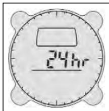
Para ajustar o horário na configuração de 24/12 horas, pressione o botão **MODE** até que seja exibido Modo de horário. Pressione e mantenha o botão **ADJ** pressionado por 3 segundos. Pressione o botão **MODE** e percorra as configurações até que apareça o ajuste do horário 24/12. Depois, pressione o botão **UP** ou **DOWN** para estabelecer o ajuste desejado. Pressione o botão **ADJ** a qualquer momento para salvar as mudanças e sair.
