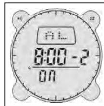
O alarme também pode ser ligado ou desligado movimentando-se até o alarme relevante e pressionando o botão **COMP** para ativar a função de alarme; pressione novamente para ativar a função Snooze, e mais uma vez para desativá-lo.
