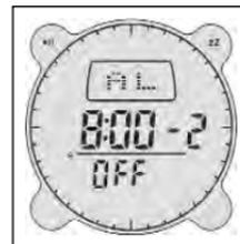
Der Alarm kann auch an- oder ausgeschaltet werden, indem man den gewünschten Alarmbereich aufruft und die Alarmfunktion durch Drücken der Taste **COMP** aktiviert. Erneut drücken, um die Schlummerfunktion zu aktivieren. Durch erneutes Drücken der Taste wird der Alarm deaktiviert.
