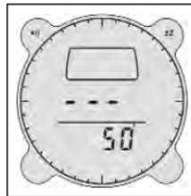
Per consumare meno potenza, in modalità Radiobussola il display mostra tre barre invece della direzione attuale e i segmenti non vengono visualizzati dopo un minuto. Per riattivare il display occorre premere **COMP**. Per uscire dalla modalità Radiobussola premete di nuovo **MODE** per ritornare alla modalità Bussola.
