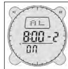
Il est aussi possible d'activer et de désactiver l'alarme en accédant à l'alarme appropriée et en appuyant sur le bouton **COMP** pour activer la fonction d'alarme, en rappuyant pour activer la fonction de Rappel et en rappuyant pour désactiver l'alarme.
