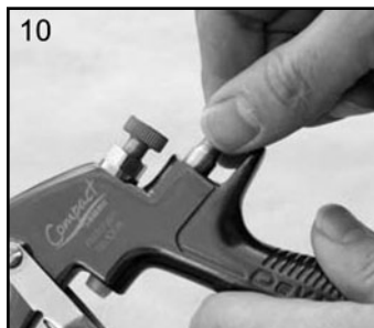
10. Coloque la junta nueva sobre el cuerpo de la pistola y empuje firmemente para asegurarse de que la junta quede correctamente colocada.
