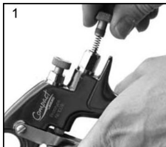
1. Retire el pomo de ajuste (7), el muelle (8), y la aguja (9).
