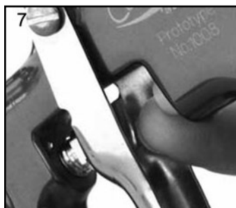
7. Haga salir la junta delantera de la válvula de aire empujando con el dedo.
